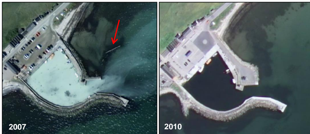
Figur 7-30 Vågbytare (vid röda pilen) öster om hamnen verkar ha försvunnit mellan 2007 och 2010.
