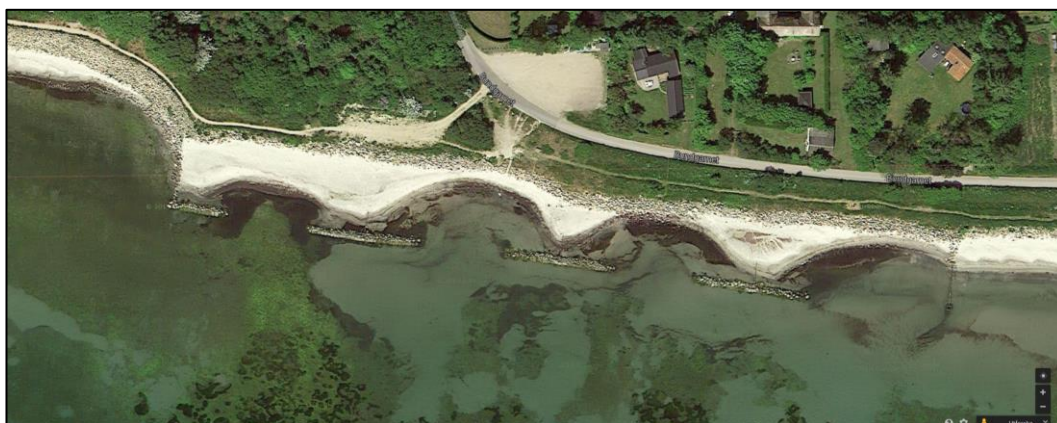
Figur 8-3 Friliggande vågbrytare på Råbylille Strand på den danska ön Mön. Strandplanet växer ut mot vågbrytarna.
